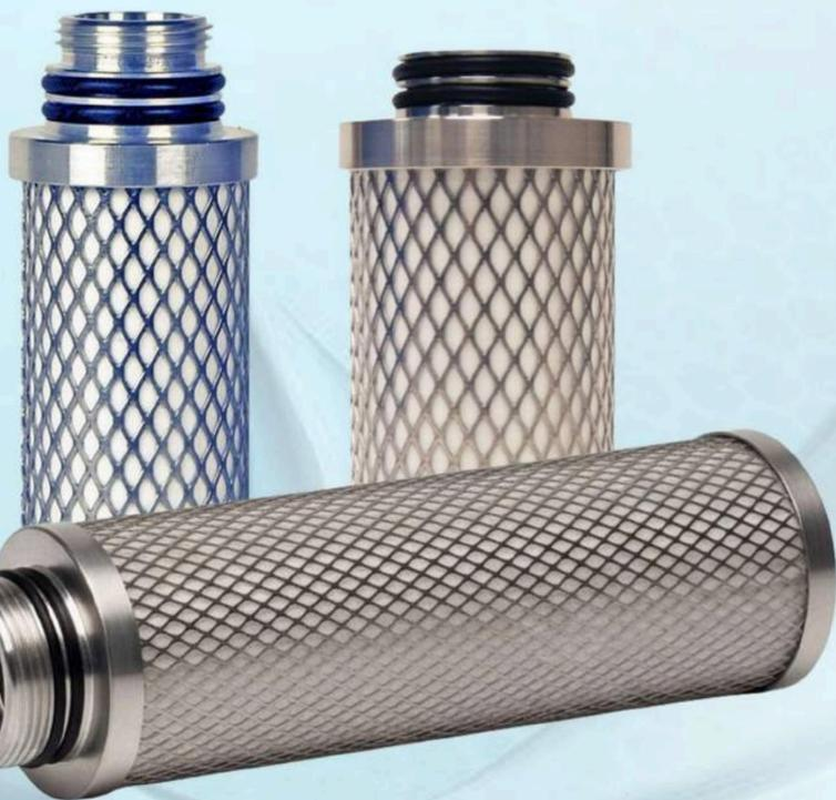
Los filtros de aceite de esta serie constan de dos etapas de filtración: una etapa de adsorción (con carbón activado) y una etapa de filtración profunda (con tejido de microfibras)
