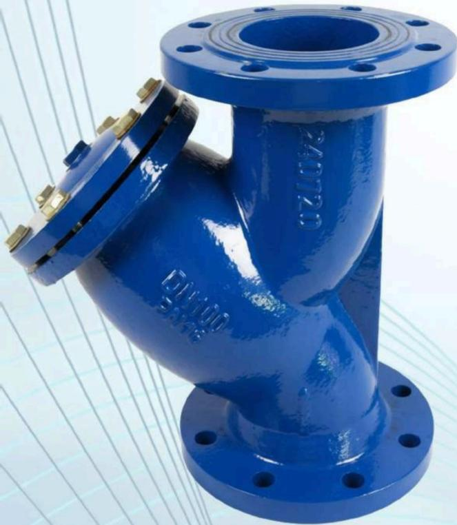
Este Filtro Tipo Y (Y-Strainer) es un componente robusto y esencial para la protección continua de su sistema de tuberías. Su diseño en forma de "Y" permite que el fluido circule con mínima perturbación mientras se desvía un porcentaje hacia la cesta de filtrado interna. Su principal función es la retención mecánica de partículas grandes (arena, óxido, incrustaciones) antes de que lleguen y dañen equipos críticos como bombas, medidores de flujo, reguladores de presión y válvulas de control.
