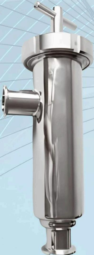
Este filtro es un Filtro Recto o en Línea diseñado para sistemas sanitarios y de alta pureza. Su cuerpo tubular se instala directamente en la tubería y contiene una cesta de filtrado interna. Aunque a menudo se le confunde con el Tipo Y, este diseño maximiza el área de filtración con una mínima perturbación del flujo y es preferido en la industria donde la higiene y la eficiencia son críticas.
