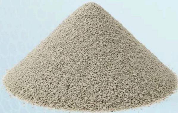
Es de origen volcánico, compuesto por Silicio y Aluminio, con una estructura microporosa única.
