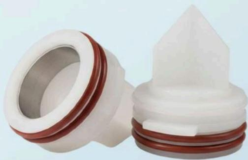
Estos tapones son componentes de precisión diseñados para sellar el extremo de un filtro de cartucho en su alojamiento (housing). Su función es crítica: forzar que el agua pase a través del medio filtrante (el cartucho) y no alrededor de él, asegurando que el 100% del flujo sea tratado antes de avanzar en el sistema.
