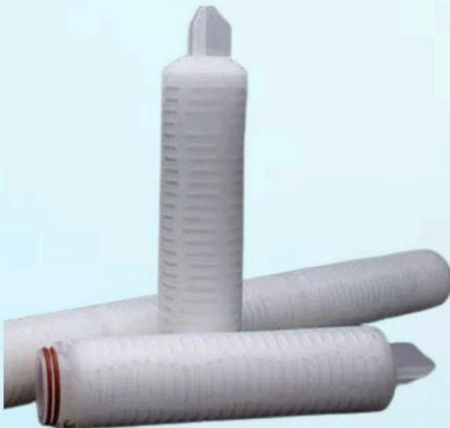
Es un filtro plisado con membrana de PTFE hidrofóbica de alta porosidad. Se caracteriza por alto flujo, baja diferencia de presión, larga vida útil y amplia compatibilidad química. Su diseño es ideal para la filtración de productos químicos y gases de baja tensión superficial.
