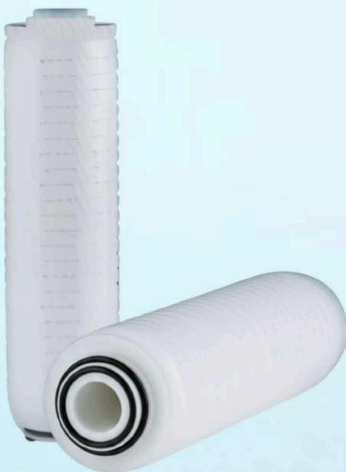
El Cartucho Filtrante de Flúor Serie ACG es un filtro de alta especialización, diseñado con una estructura íntegramente de flúor para entornos extremadamente exigentes. Está soldado y sellado con resina PFA ultrapura y una membrana de PTFE termofusible.
