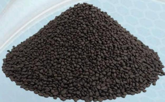
Medio filtrante de arcilla expandida con estructura altamente porosa.
